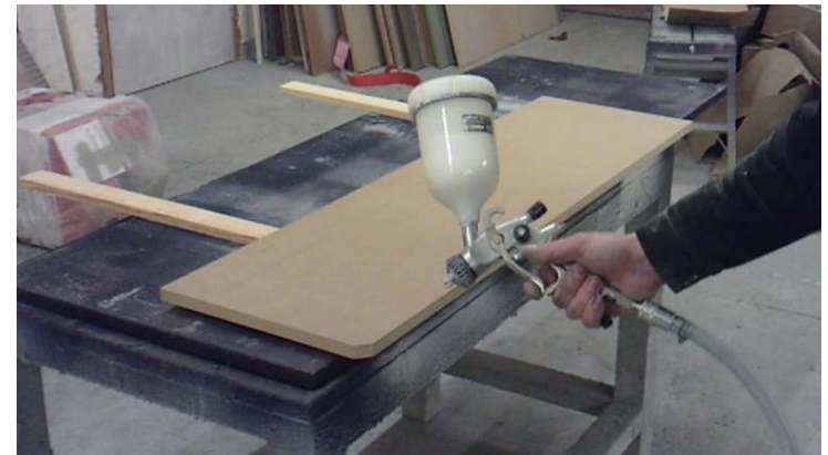
<Ví dụ về quy trình thứ hai của MDF. Phun sơn MDF>
